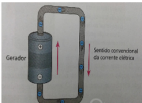
Figura 3: Sentido convencional da corrente elétrica
